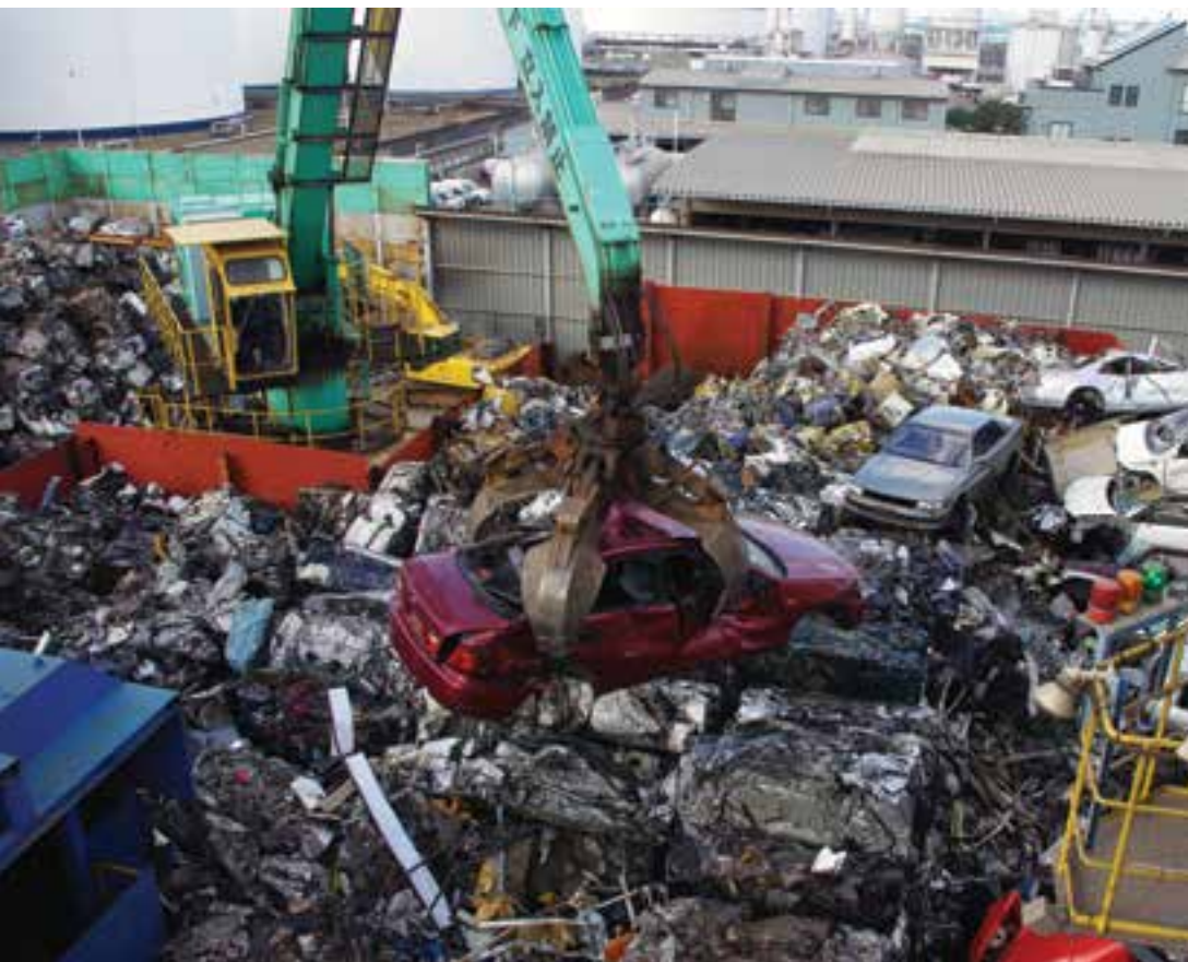
Área de armazenamento de carcaças e grua segurando o veículo pronto para a fragmentação ECOTEC KANESHIRO - Japão
