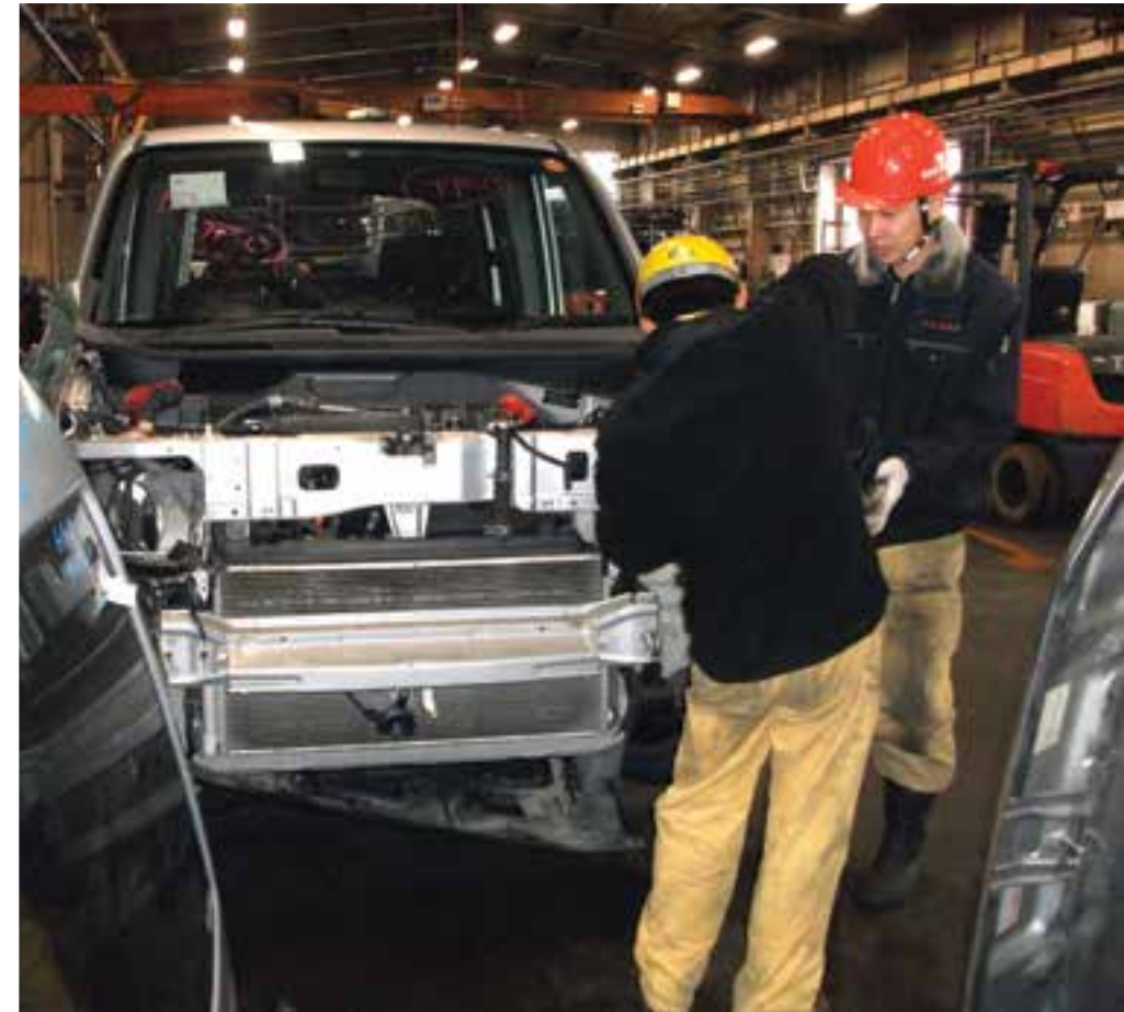
Desmontagem manual de componentes de ELV's - KAIHO SANGYO – Kanazawa - Japão
