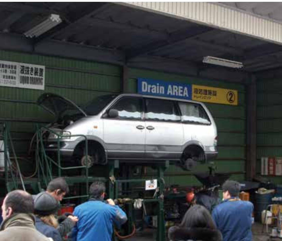
Área de descontaminação e drenagem de fluidos na empresa KAIHO SANGYO – Kanazawa - Japão
