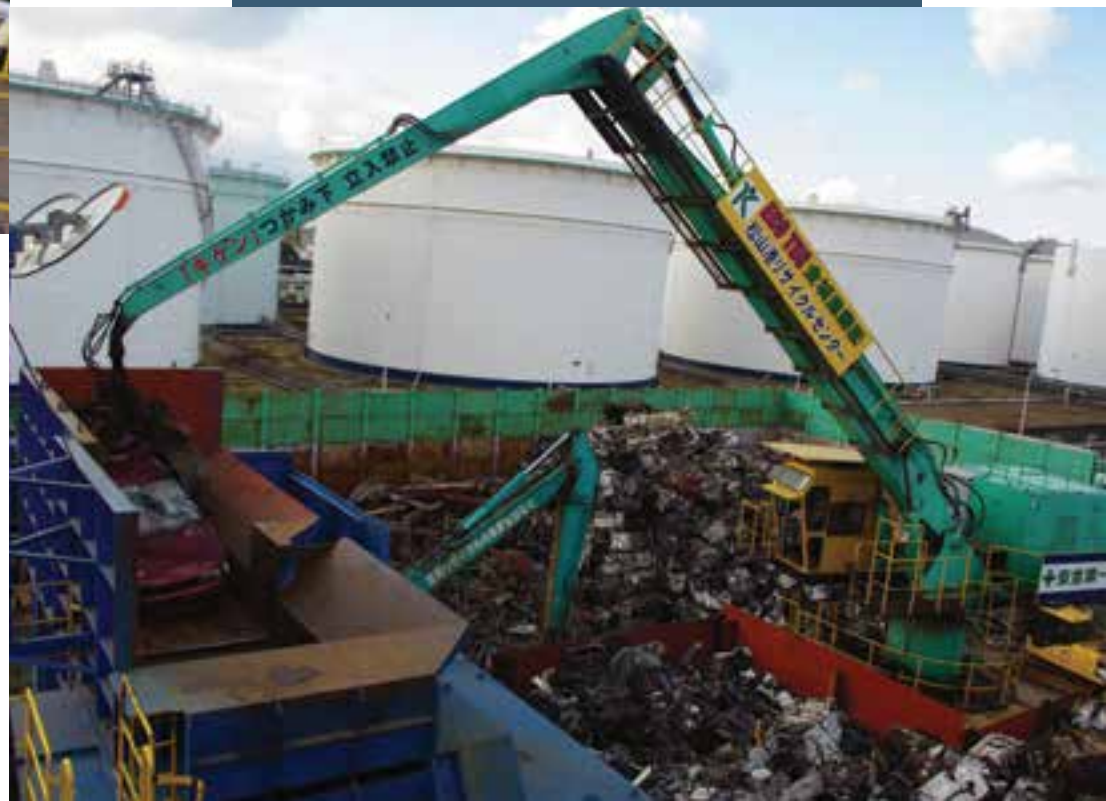
Alimentação da fragmentadora com uma carcaça ECOTEC KANESHIRO - Japão
