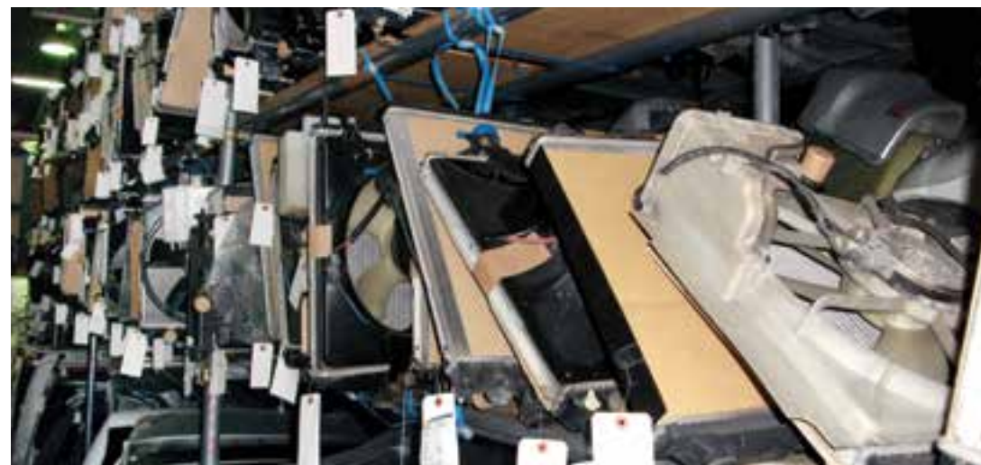
Componentes do sistema de refrigeração do motor retirados de ELV's KAIHO SANGYO – Kanazawa – Japão
